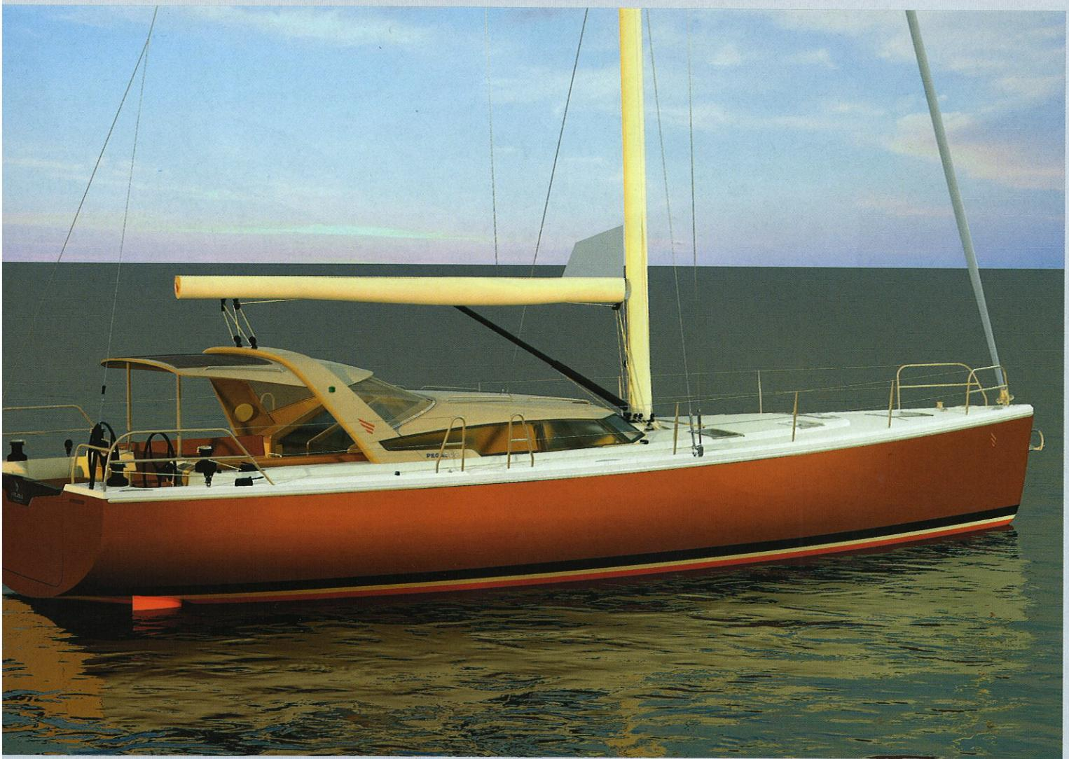
vessel), kar pomeni, da varno križari tudi pri vetrovih, močnejših od 40 vozlov, in kljubuje valu višine nad 4 metre. Bistveni elementi varnosti, kot so čvrstost konstrukcijskih elementov, stabilnost, nadvodje, rezervna plovnost idr., so zato skrbno načrtovani, nadgrajeni in okrepljeni.
